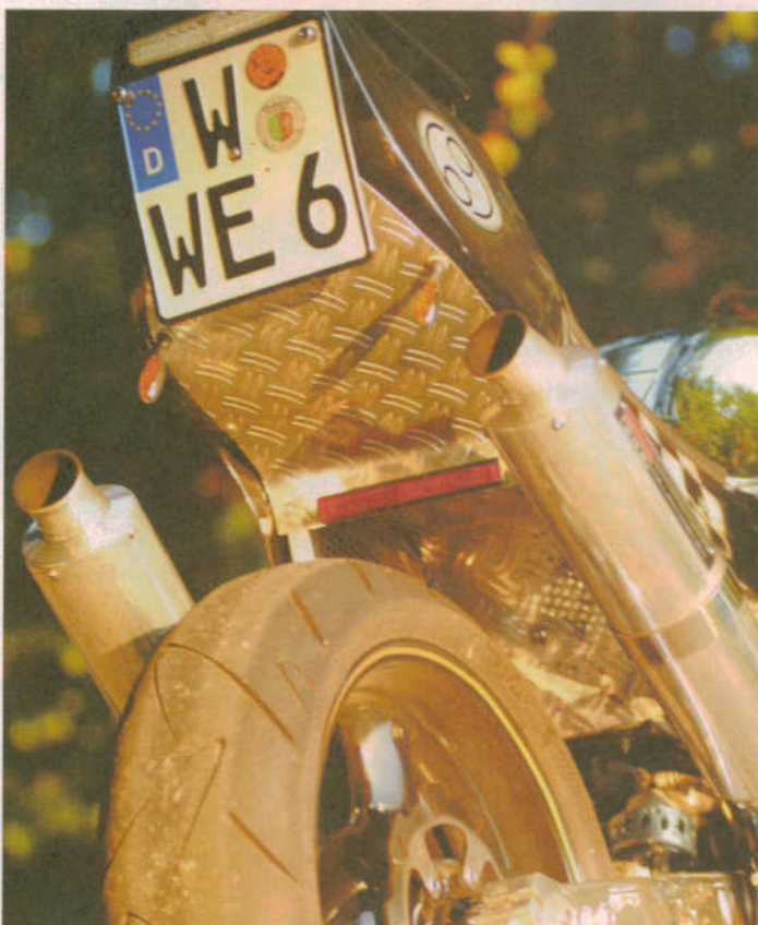
Steiles Heck: Yoshimura Race Endtöpfe haben den Weg in den Himmel schon mal ins Zyklopaenge gefasst, der gekürzte Heckrahmen gibt die Sicht frei. Ursprünglich stammt der Heckkorpus von Egli, wurde aber mit eingearbeitetem Riffelblech, Gepäckbrücke und LED-Rücklicht stark modifiziert.
